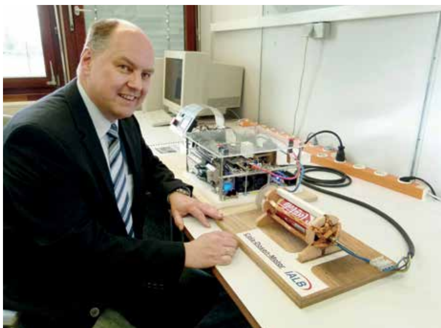
Cola einmal anders: Professor Nando Kaminski zeigt einen Schülerversuch, bei dem die Blechdose als Rotor einer Asynchronmaschine verwendet wird. Cola with a difference: Professor Nando Kaminski shows a school experiment in which the can is used as a rotor for an asynchronous machine.
