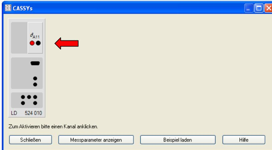
Am Sensoreingang **gemittelte Werte** aktivieren und als Messgröße bzw. Messbereich  $-20^{\circ}\text{C} \dots 120^{\circ}\text{C}$  einstellen.
