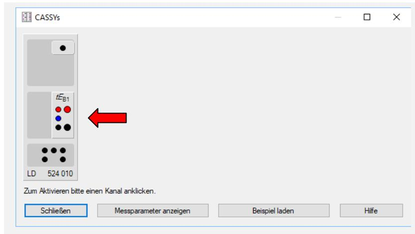
Am Sensoreingang **Dunkelzeit  $tE_{B1}$  (E)** aktivieren. Es können nun mehrere Dunkelzeiten der Lichtschranke aufgenommen werden. Mit **rechtem Mausklick** auf das Diagramm **> Mittelwert einzeichnen** kann die durchschnittliche Dunkelzeit bestimmt werden.
