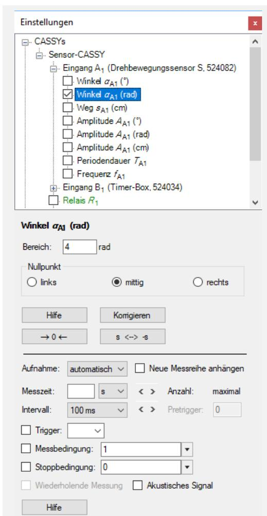
Kurz vor Beginn der Messung den Winkel  $\alpha_{A1}$  mit dem Button  $\rightarrow 0 \leftarrow$  auf Null stellen. Es kann nötig sein die Winkelzählrichtung mit dem Button  $s < -- > -s$  zu ändern.
