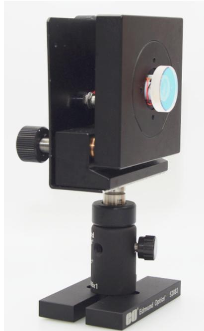
**Abb. 19:** Spiegelhalterung des dielektrischen Spiegels mit Piezoaktor und rückseitigen Anschlussbuchsen.
